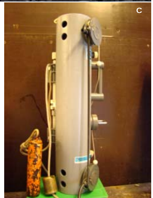
Figura 2. Equipamientos para las tomas de muestra. a) Bote y traje antiexposición. b) CTD (sonda para medir temperatura, salinidad y profundidad). c) Botella de Niskin para tomar agua de profundidad.
